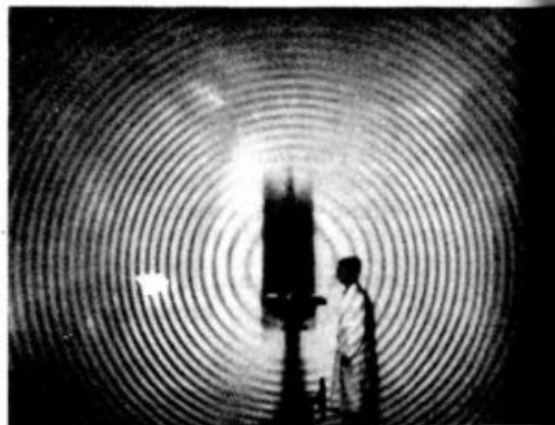
Experiencia de interferencia de haces reflejados en las dos caras de delgadísimas láminas de mica. (Según R. W. Pohl.)
