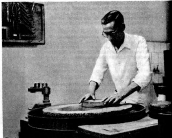
Pulido de un espejo en el Observatorio de Córdoba.
