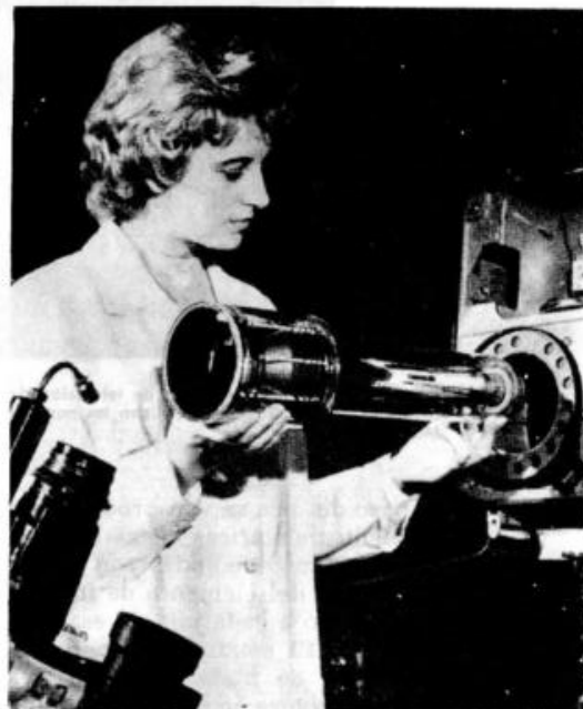
Un tubo orthicon de televisión es introducido en el tester para ser probado.
