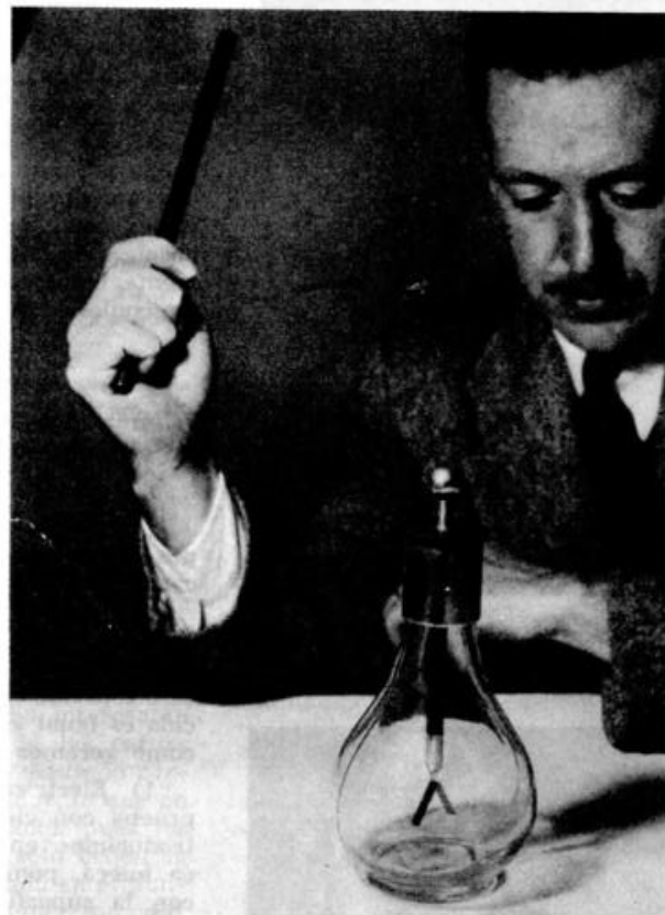
Las cargas positivas se distribuyen por todo el electroscopio; las hojuelas se abren.
