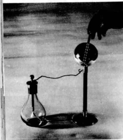
Conductor cargado por contacto y por inducción; el mismo número de cargas. (Siempre que el inducido rodee completamente al inductor.)
