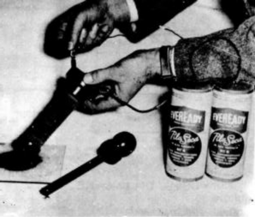
Las fotografías muestran el efecto de un núcleo de hierro en el solenoide. Arriba): El solenoide apenas atrae. Centro): La introducción de una parte de la barra de hierro aumenta la fuerza de atracción. Abajo): Con la barra totalmente introducida, la atracción es máxima.
