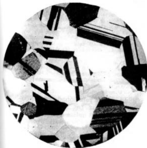
Fotomicrografía de una probeta de latón cuya composición es de 70 % de cobre y 30 % de cinc.
