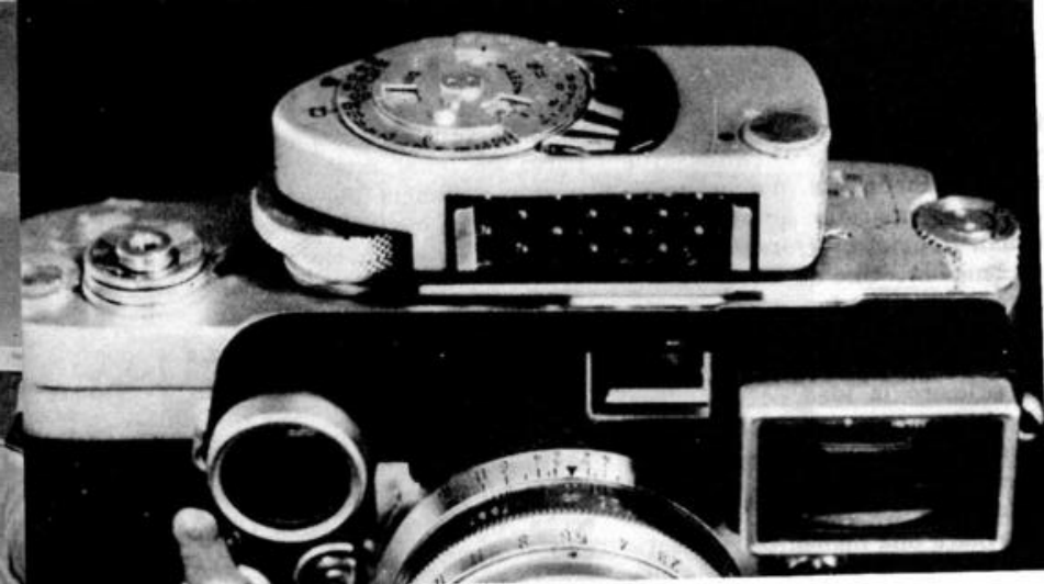
Fotómetro fotoeléctrico acoplado a una cámara fotográfica.
