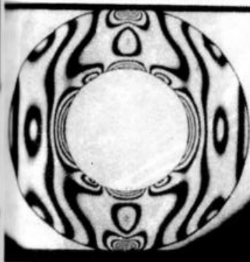
Diagrama de tensiones de un anillo comprimido diametralmente.
