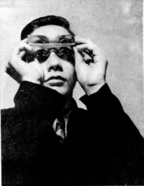
Der.): Un rayo de sol incide sobre la cara del prisma, cerca de la arista, y es desviado hacia la base. Obsérvese que el ángulo de desviación es de 30^\circ . Iza.): Con un prisma, las cosas se ven "más arriba".
