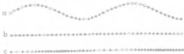
a) Partículas en un medio en el que se propaga una onda transversal. — b) Partículas en un medio en reposo. — c) Partículas en un medio en el que se propaga una onda longitudinal.
