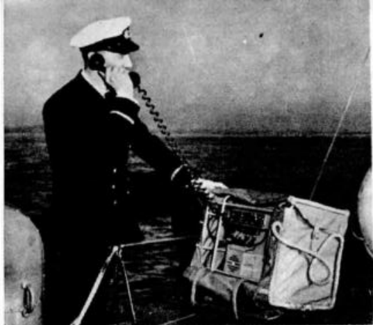
Radioteléfono transportable VHF, tipo HP 868, usado por la Dirección del Puerto de Southampton, en una lancha de control.
